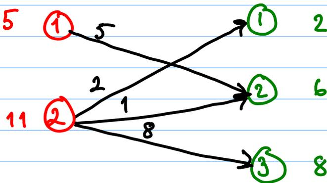
Als we alle pijlen ongericht maken is een basisoplossing in dit netwerk een **opspannende boom!**
