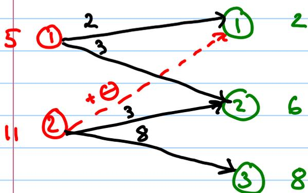
Door het toevoegen van kant (2,1) in het netwerk wordt een **unieke kring** gecreëerd. De stroom in deze kring moet in evenwicht.
